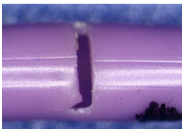
Figura 1: Exemplet de fisură transversală/circumferențială în corpul cateterului
